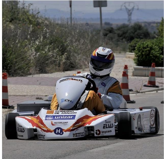
■ El bólido, accionado por pila de combustible de hidrógeno
