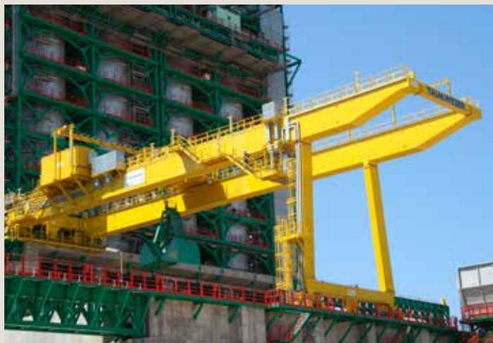
> Máquina apiladora-recogedora fabricada por TAIM WESER.
