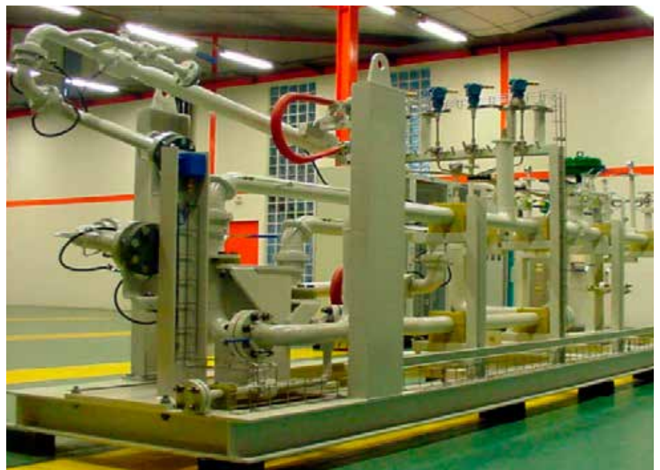
> Skid de carga GNL para terminal de regasificación de Bahía de Bizkaia Gas.
